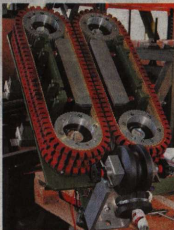
Główną część robota stanowi napęd gąsienicowy.
