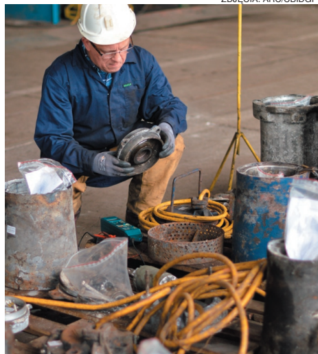
Ocena stanu technicznego urządzenia – przenośnych pomp zatapialnych – realizowana w I etapie nadzoru eksperckiego nad remontami maszyn i urządzeń górniczych.
