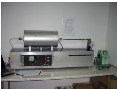
Ryc. 2. Urządzenie do oznaczania wskaźników samozapalności węgla
